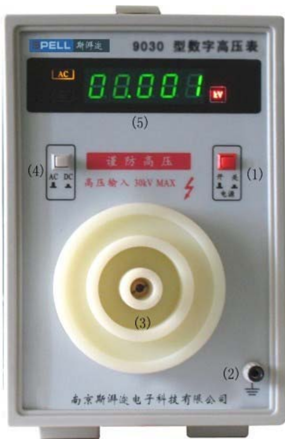
图 1 数字高压表前面板示意图
