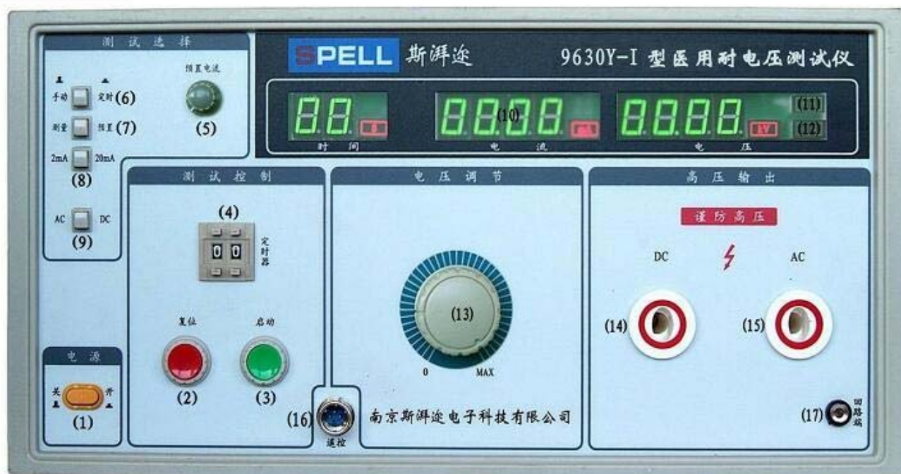
图（2）医用耐压测试仪前面板示意图
